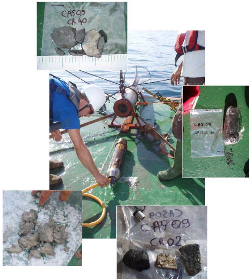
Figure 5- 1: Carottier à roche CNEOX-VILLE utilisé lors de la campagne CASSEIS (2009) et photos de quelques échantillons carottés sur le fond marin.
