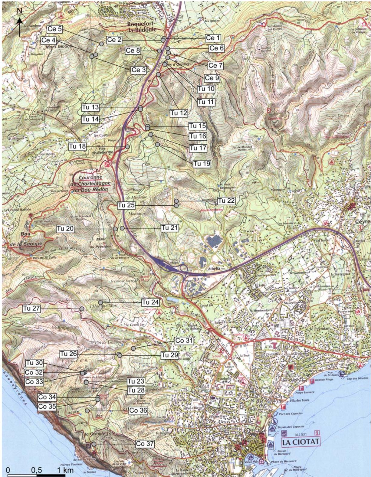
**Annexe 2A.** Localisation des échantillons de roches prélevés pour les mesures pétrophysiques (plug : diamètre 2,5 cm). Les échantillons ont été extrait parallèles à la stratification, hormis Ce 9 et Co 37 pris perpendiculairement. Légende des noms : Ce : Cénomaniens ; Tu : Turonien ; Co : Coniacien.
